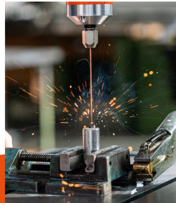
In den Schwingkopf wird die Kupfer-Hohlelektrode eingespannt. Sie ist im Durchmesser kleiner als das abgebrochene Werkzeug. Beim Erodieren wird das Kernstück des abgebrochenen Werkzeugs unter Funkenentladung verdampft.
