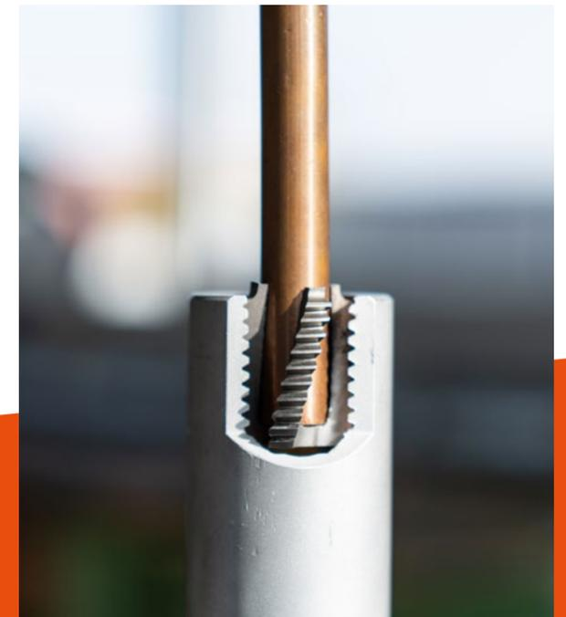
Beim Verdampfen lösen sich die Schneiden und können leicht entfernt werden. Mit dem Werkstück kommt die Elektrode nicht in Berührung, das Gewinde bleibt unbeschädigt. Als Kühlflüssigkeit wird die im Betrieb übliche Bohremulsion verwendet.
