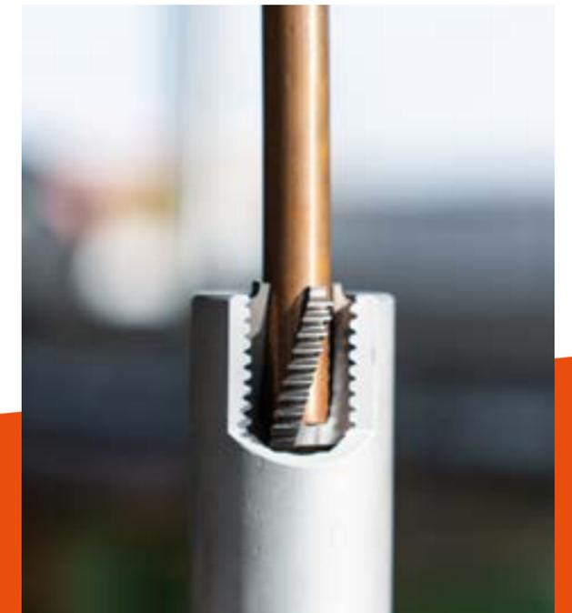
Beim Verdampfen lösen sich die Schneiden und können leicht entfernt werden. Mit dem Werkstück kommt die Elektrode nicht in Berührung, das Gewinde bleibt unbeschädigt. Als Kühlflüssigkeit wird die im Betrieb übliche Bohremulsion verwendet.
